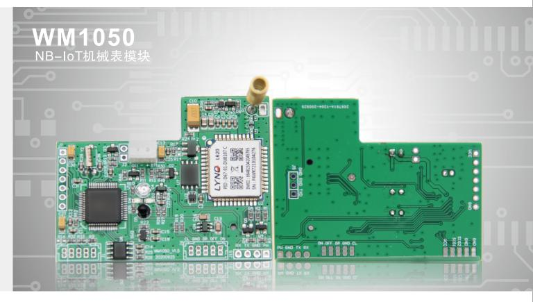
NB-IoT机械表模块具有两对脉冲信号 检测端口,通过检测两个端口的脉冲信号及设定好的脉冲当量,可以计算当前流量值并进行存储,可记录结算日流量。模块在检测脉冲信号 时进行防抖处理,可有效避免因外界干扰造成的误计量,提了计量准确度。
