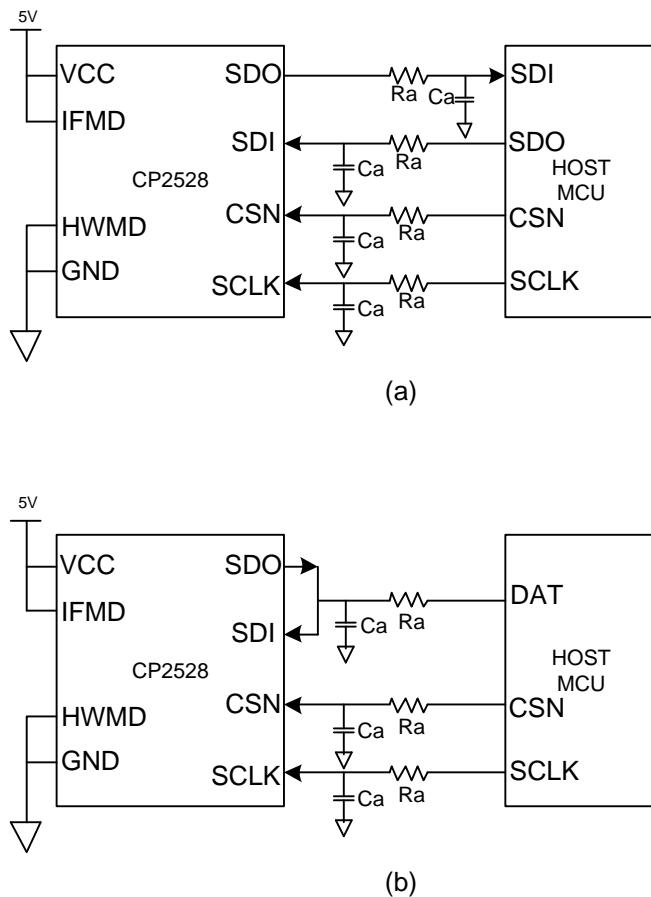
图 11 SPI 典型配置，(a) 为 4 线 SPI，(b) 为 3 线 SPI
