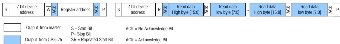
图 18 IIC 读操作
