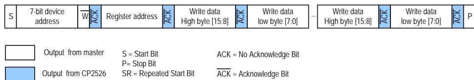
图 17 IIC 写操作
