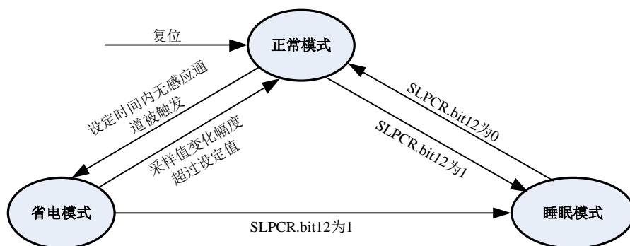
图 9 CP2528 的三种工作模式转移图
