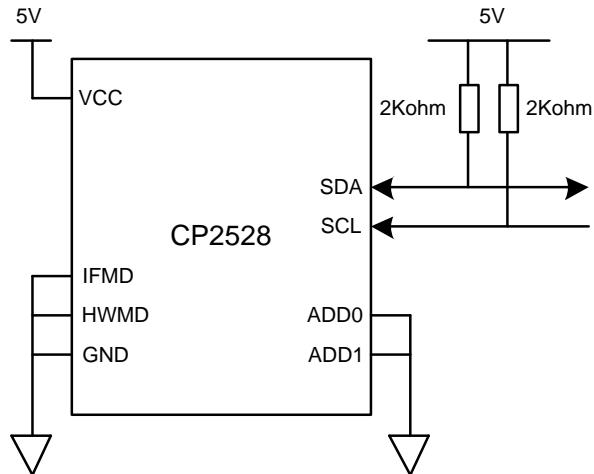
图 15 IIC 典型配置
