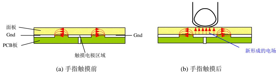
图 7 电容触摸感应原理示意图
