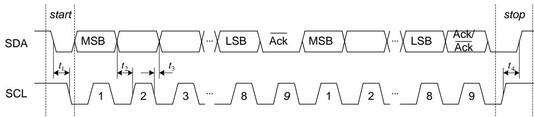
图 16 IIC 时序图
